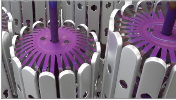
Das Zusammenspiel von Aluminiumlegierung, sorgfältigster Vorbehandlung der vorgefertigten Teile (entfetten, beizen) sowie eine hohe Fertigungskompetenz garantieren einen wirksamen Schutz gegen Korrosion.
