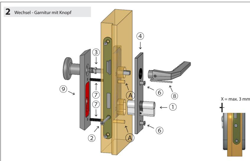
Zur Markierung der Schraublöcher das Innengrundschild über den Profilzylinder und den Stift schieben.
