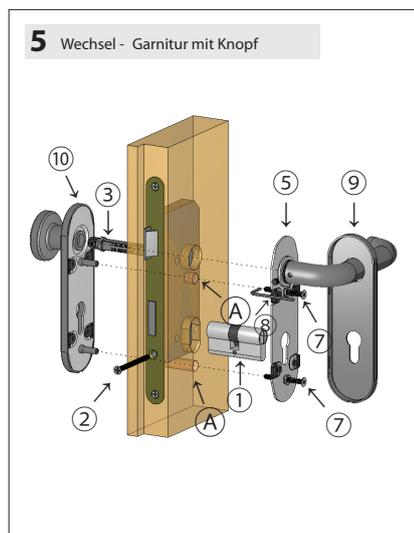
Zur Markierung der Schraublöcher das Innengrundschild über den Profilzylinder und den Stift schieben.
