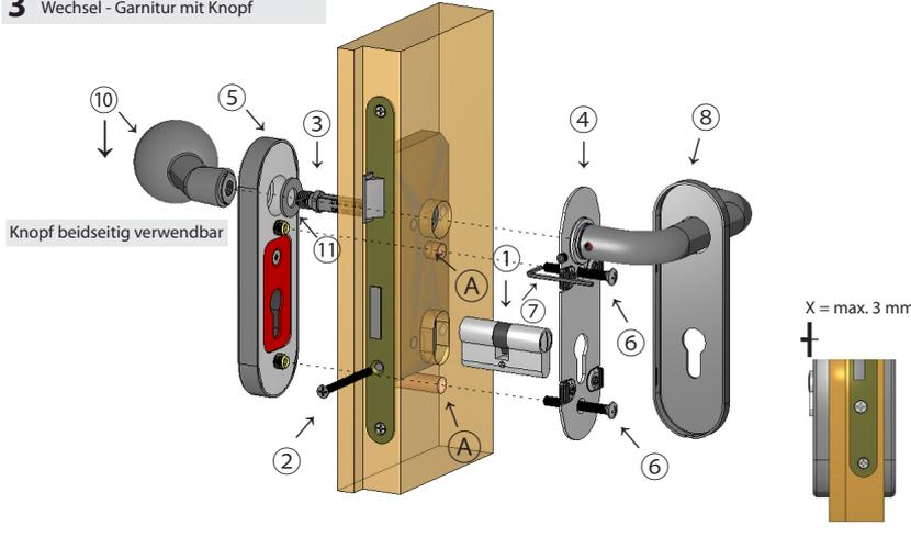
Der DIN 18 273 : 1997 folgend sind Befestigungselemente prüfungsrelevante Bestandteile der Dieckmann-Beschläge für Feuerschutz-, Rauchschutz- und Fluchttüren und dürfen nur mit diesen zusammen als eine Einheit eingesetzt werden. Die Montage muss nach Anleitung und von einer qualifizierten Person durchgeführt werden. Bei Nichtbeachtung entfällt jeglicher Anspruch auf Gewährleistung.
