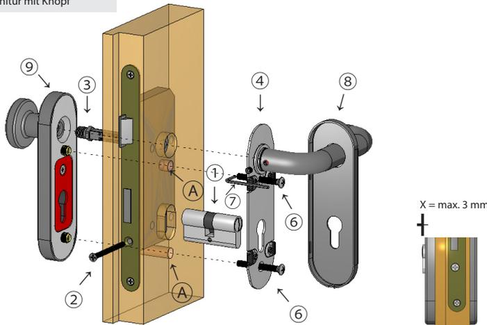
Zur Markierung der Schraublöcher das Innengrundschild über den Profilzylinder und den Stift schieben.
